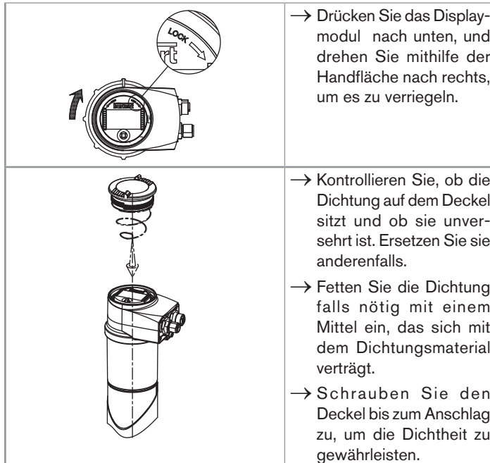
Bild 7: Einbau des Displaymoduls
